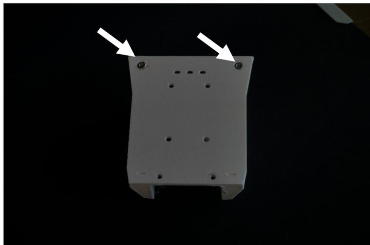
Auf der Oberseite werden ebenfalls noch zwei DIN 934 M3 Außensechskantmuttern eingesetzt
