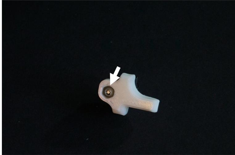
Die Achsaufnahmen können nun magnetisch an die Lenkstange angebracht werden
